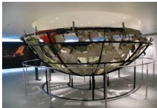
安全啓発センターに展示されている事故機の圧力隔壁(現物)
