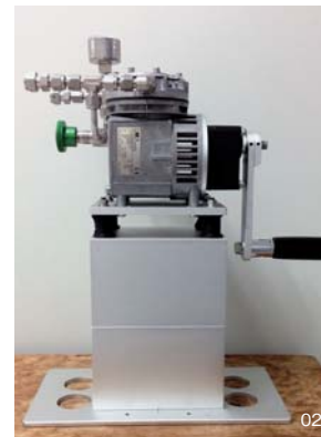
01. フラスコ。02. 手動ポンプ。 03. 操縦室内での手動観測の様子。後席でポンプを回す国立環境研究所の研究者（写真内・右）。（この写真は、運航の安全を確保した上で撮影しています。）
