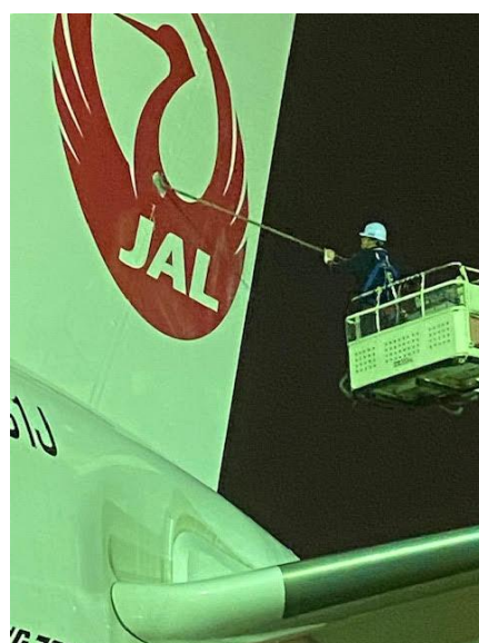
垂直尾翼のモップによる洗浄
