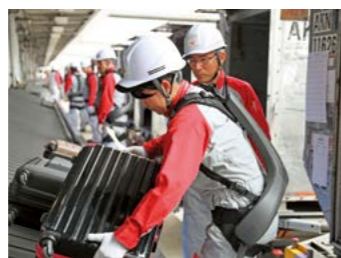
パワードウェア ATOUN MODEL Y* 腰をサポートする着用品ロボット。手荷物を持ち上げるとセンサーが体の動きを認識し、内蔵されたモーターを自動調整して、作業員の腰への負担を和らげる ※ATOUN社製
