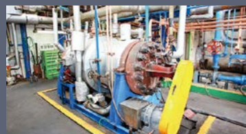
アルコール(イソブタノール)を触媒反応させ、バイオジェット燃料を生成する (写真提供: 高压化学工業株)
