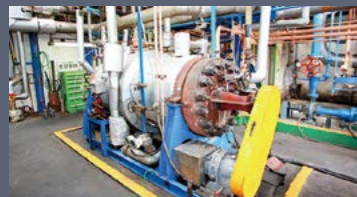
アルコール(イソブタノール)を触媒反応させ、バイオジェット燃料を生成する (写真提供: 高压化学工業株)
