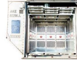
特殊な蓄熱材と真空断熱材により、コンテナ内の温度を5度前後に維持
