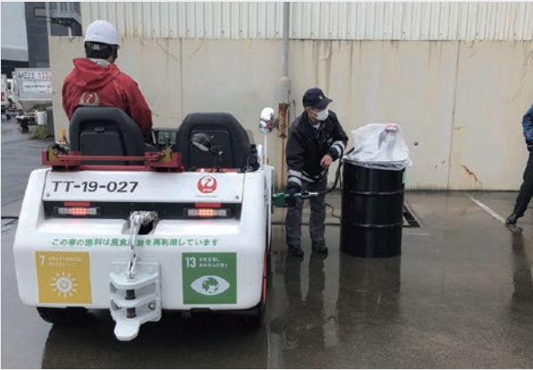
B100燃料の給油の様子（成田空港）
