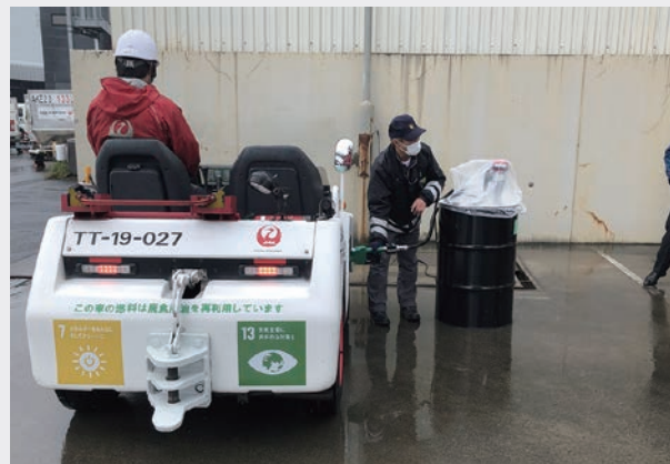
B100燃料の給油の様子（成田空港）
