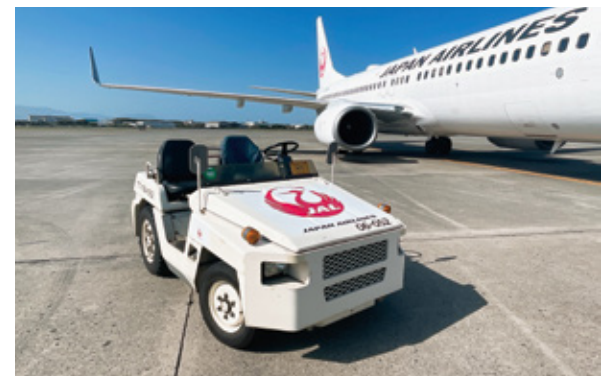
地産地消の循環型エネルギーである高純度バイオディーゼル燃料を空港車両に利用
