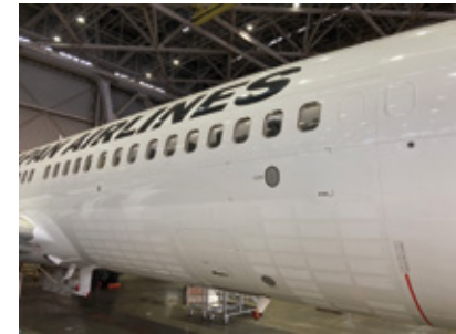
2023年11月、ボーイング737-800型機の胴体下部に、合計約25m 2 のリブレット形状を施工
