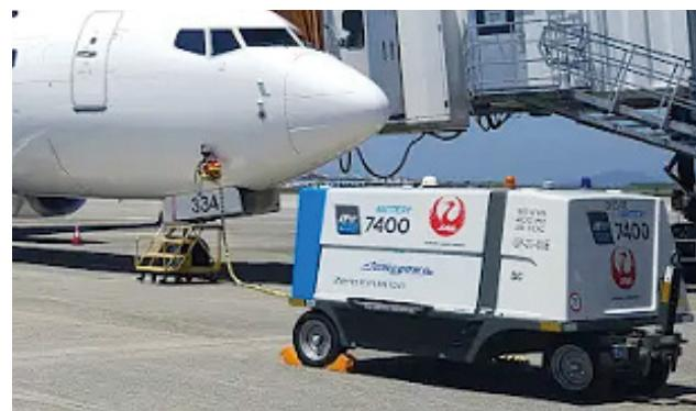
リチウムイオンバッテリー式電源装置「eGPU」
