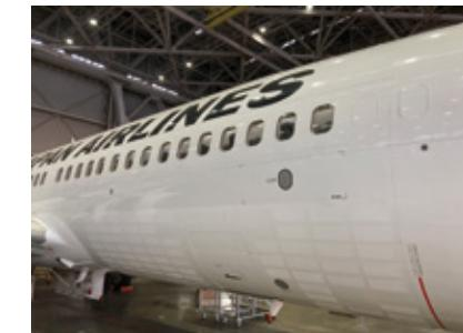
2023年11月、ボーイング737-800型機の胴体下部に、合計約25m<sup>2</sup>のリプレット形状を施工
