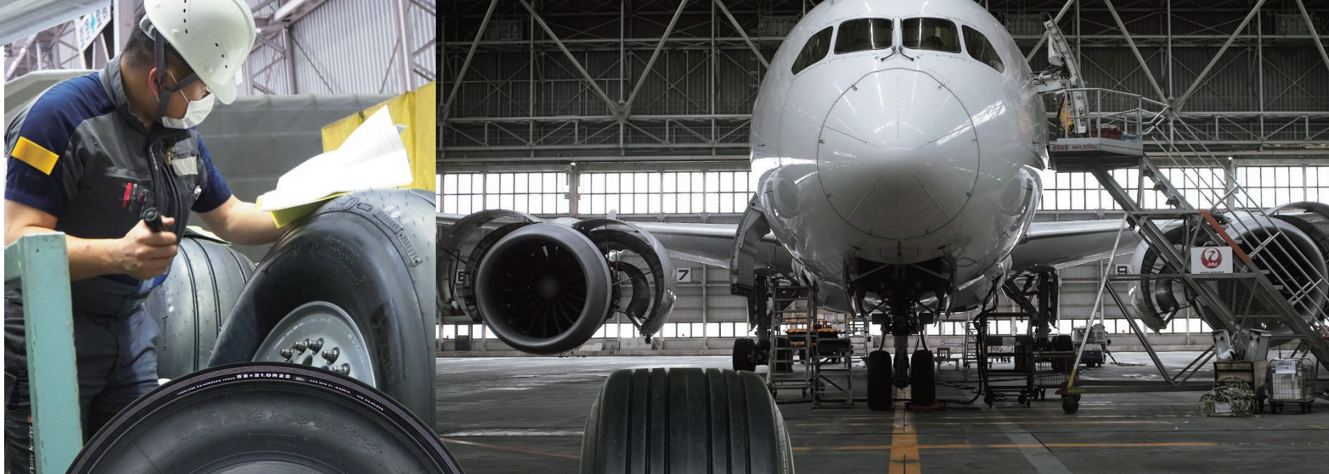
1.ボーイング787型機は前脚に2本、主脚に左右4本ずつのタイヤ構成。2.タイヤ点検の様子。
