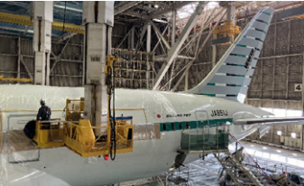
JA851Jヘリブレット加工を施工する様子
